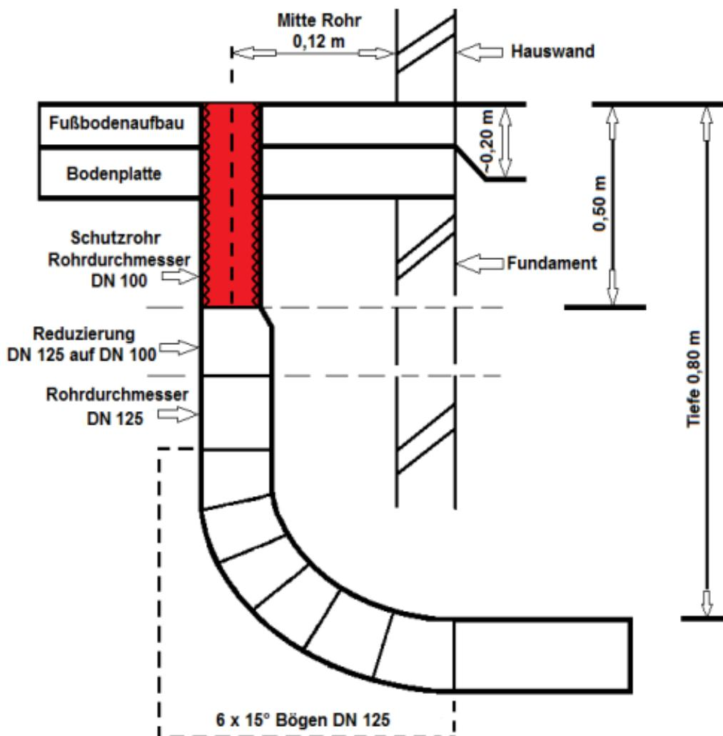
**Das rot gekennzeichnete Schutzrohr wird von der Stadt- und Überlandwerke Lübben zur Verfügung gestellt.**
