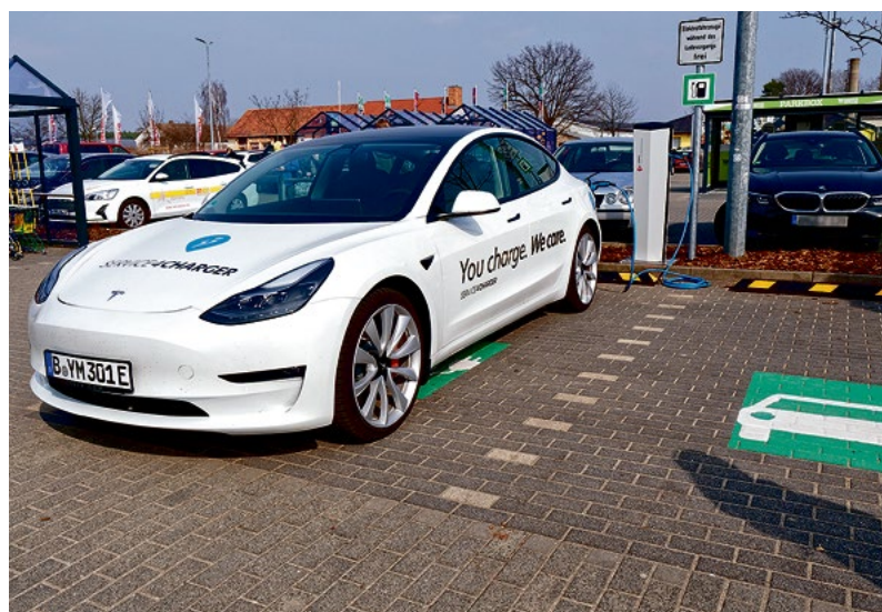
Die Stadt- und Überlandwerke haben die Ladesäule aufgestellt und betreiben sie. Zwei Ladepunkte á 22 kW sind dort vorhanden.
